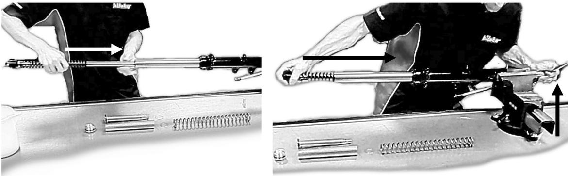
Posizionare la forcella in verticale con lo stelo alla massima compressione. Versare olio Bitubo cod. 997630 (ISO 22) fino a 145mm dal bordo superiore. Come indicato nella tabella "1" nella sezione SET-UP DI BASE (pag. 1). Eseguire alcune compressioni ed estensioni della canna forcella per permettere il corretto caricamento dell'olio.
