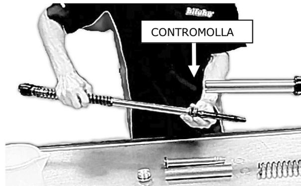
15. Mantenendo lo stelo sul fondo del fodero inserire la cartuccia BITUBO dentro alla forcella e fissarla con la vite a brugola e rondella originali, serrando adeguatamente con la coppia di serraggio indicata dalla casa madre.
