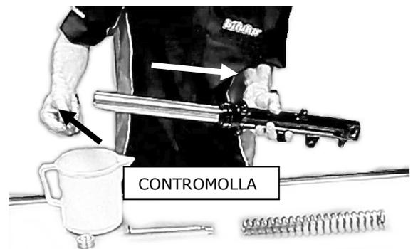
14. Inserire la contromolla originale nel distanziale inferiore della cartuccia BITUBO.
